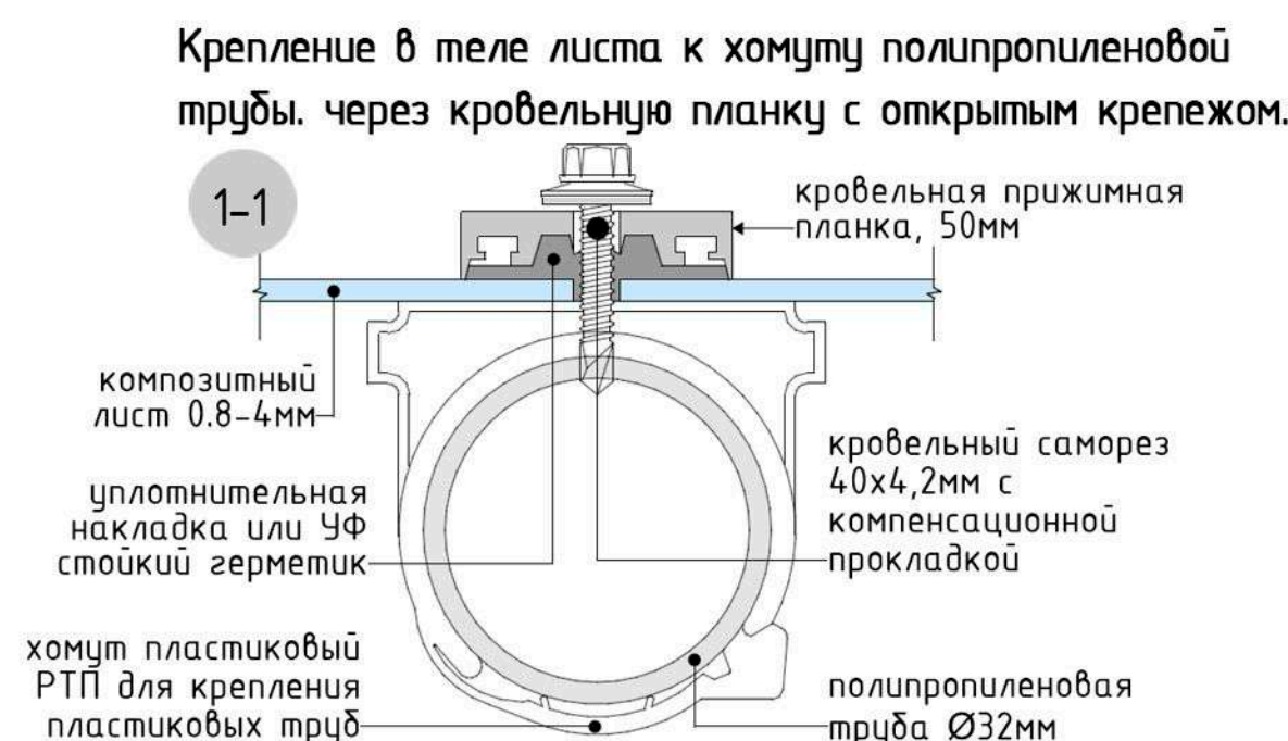
Крепление в теле листа к хомуту полипропиленовой трубы. через кровельную планку со скрытым крепежом.
