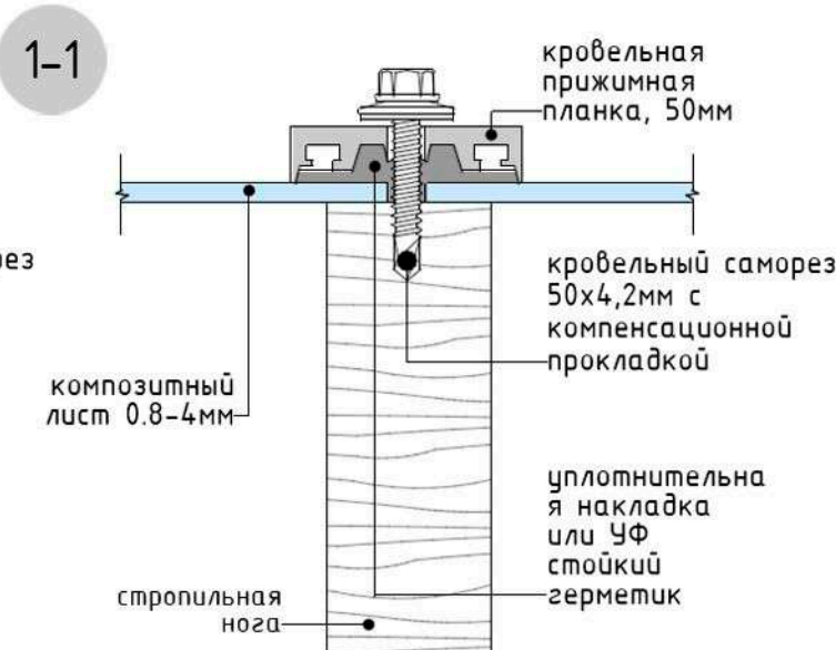
Крепление в теле листа к брсу через кровельную планку со открытым крепежом.
